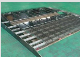
板金+溶接 板金筐体 SUS304 2~6mm 1200×1200×100
