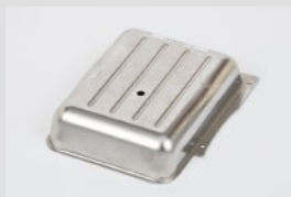
プレス+3Dレーザー切断 試作品 SUS304 1.0mm 100×70×30
